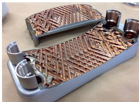
Figura 9 - Chiller de placas seccionado mostrando os vasos internos
