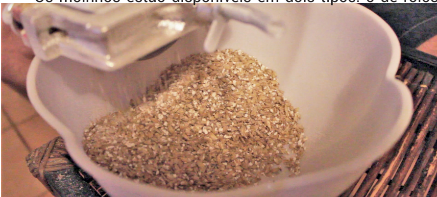
Figura 2 - Moagem do malte caseira utilizando moinho de disco.
