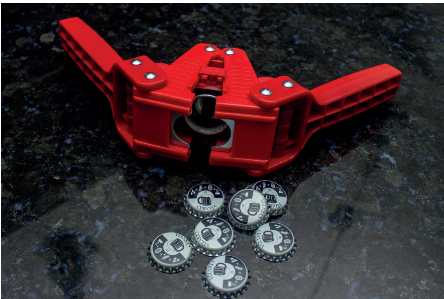
Figura 10 - Equipamento utilizado para prensar as tampas e tampas pry-off
